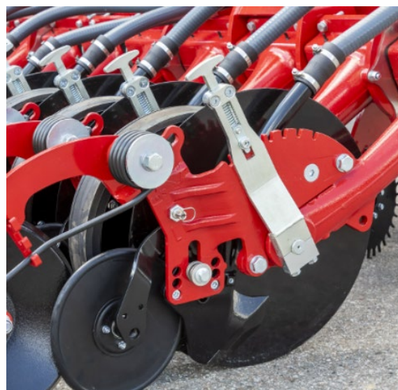
Kiire ja lihtne individuaalne küvisügavuse muutmine
