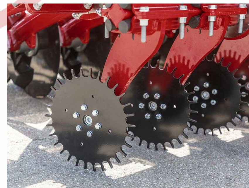
Trash Wheels ehk puhastuskettad enne seemendeid. Vajalik suurema põhumassi korral
