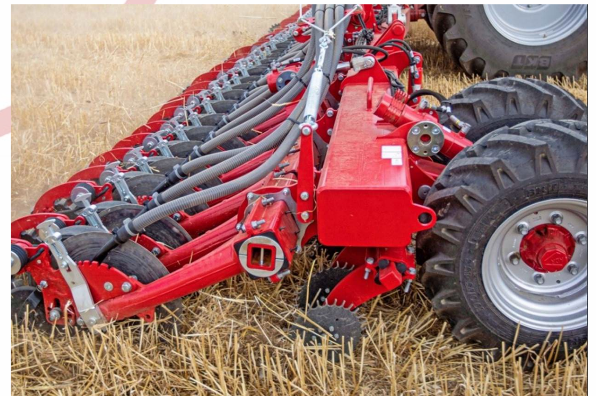
Trash Wheels ehk puhastuskettad enne seemendeid. Vajalik suurema põhumassi korral
