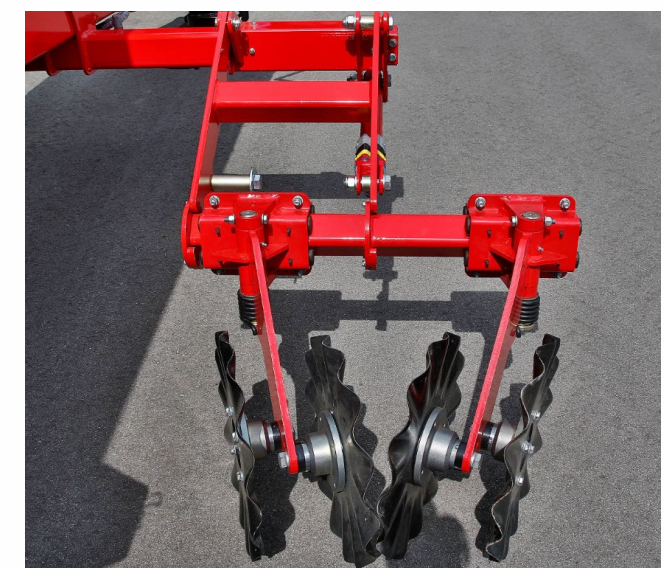
Hüdrauliliselt liigutatavad jäljekobestid
