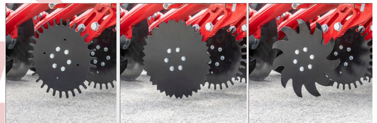
Trash Wheels ehk puhastuskettad enne seemendeid. Vajalik suurema põhumassi korral
